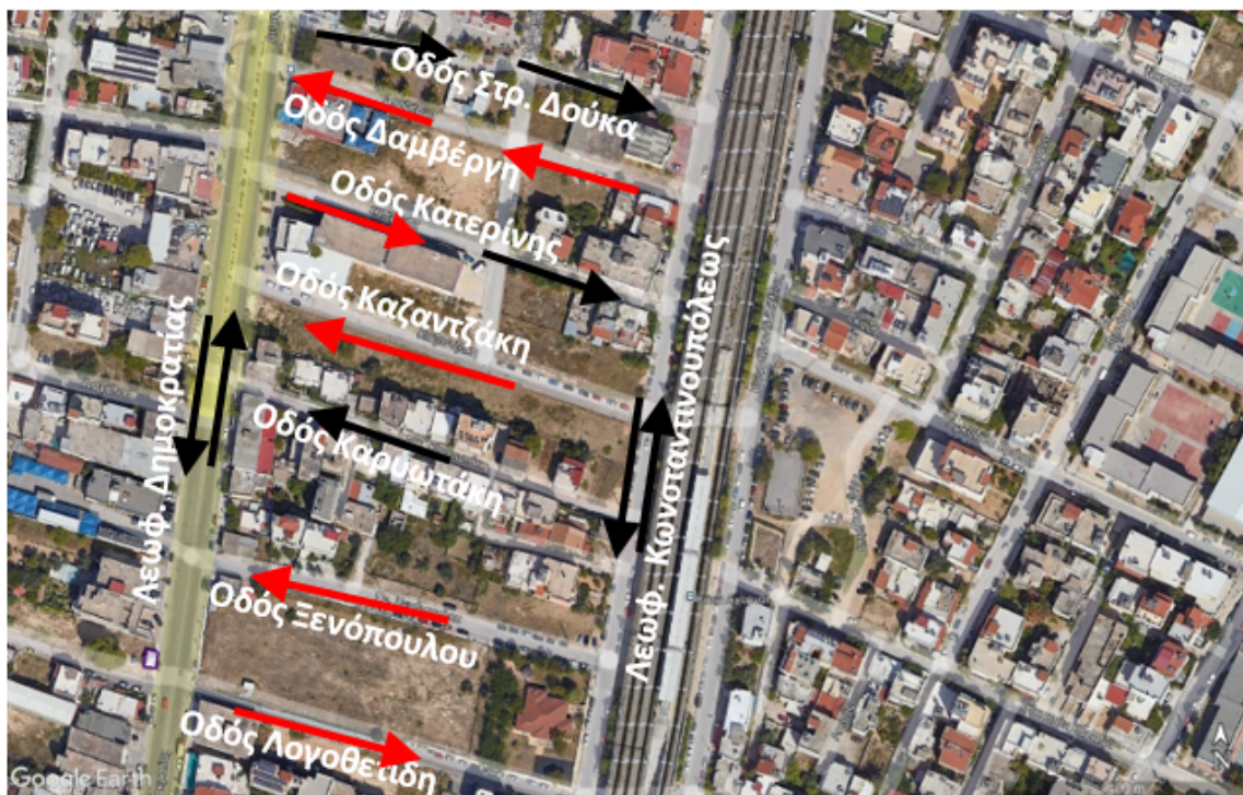
Εικόνα 12 Πρόταση μονοδρόμησης οδών Λογοθετίδη, Ξενόπουλου, Καζαντζάκη, Κατερίνης και Δαμβέργη (με κόκκινο χρώμα σημαίνεται η πρόταση κίνησης των οχημάτων, ενώ με μαύρο η υφιστάμενη κατάσταση που διατηρείται)
